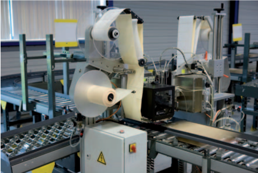
Ettikiermaschine, gesteuert von einer SPS der L-Serie
